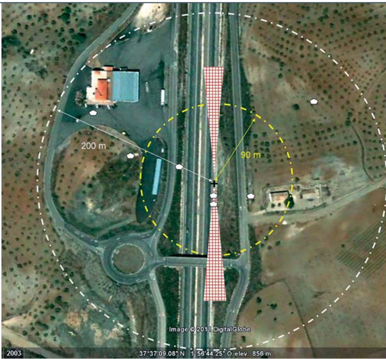
Figura 12. Radio de acción de la explosión y zona de caída de los rompeolas. Ilustración: Autores.
