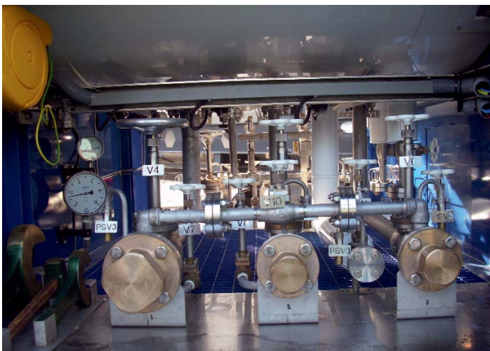
Figura 7. Vista general del conjunto de válvulas y conducciones. En primer término, las bocas de carga y descarga. En la fotografía derecha, detalle de las válvulas obturadoras interiores. Fuente: Autores.
