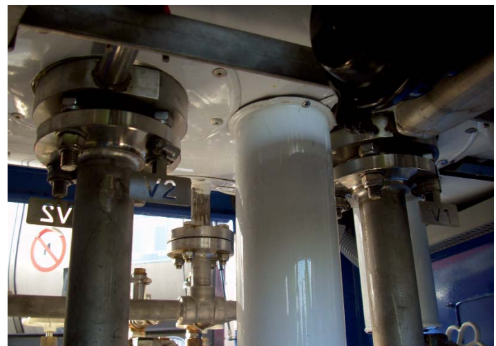
Figura 7. Vista general del conjunto de válvulas y conducciones. En primer término, las bocas de carga y descarga. En la fotografía derecha, detalle de las válvulas obturadoras interiores. Fuente: Autores.
